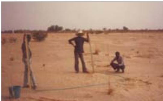
Niveau à eau permettant de déterminer les courbes de niveau
